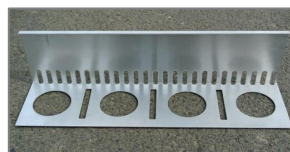
Kiesleisten mit Sonderlochungen im Auflageschenkel zum sicheren Einkleben mit Bitumen/Kunststoffbahnen
